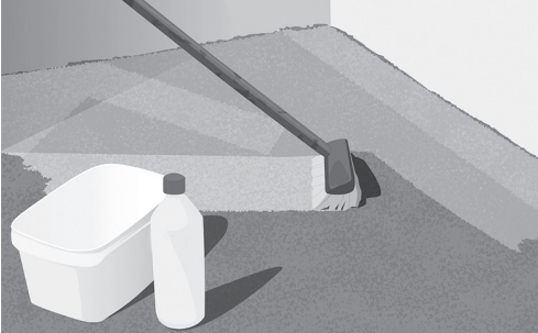
Fig. 7. Rengör och grunda golvet
